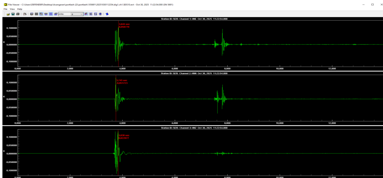
Изображение-3. Временные формы ускорений по трём компонентам акселерометра №105691 (в единицах g) во время взрыва 11:23. Показан чёткий импульс длительностью ~0.6 с с максимумами 0.07 g на горизонтальных компонентах.
