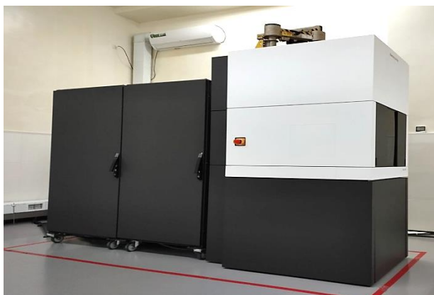
Рисунок 2- Thermo Scientific Talos F200i (S) TEM - трансмиссионный электронный микроскоп.
